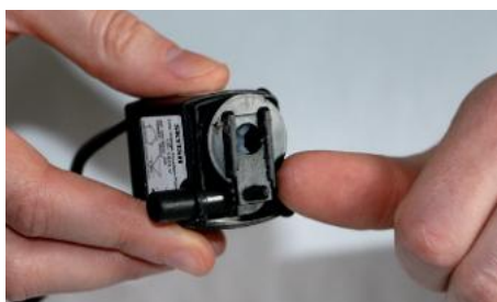
4) Motorgehäuse herausziehen / Pull out the engine housing
