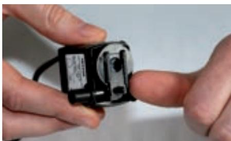
4) Motorgehäuse herausziehen / Pull out the engine housing
